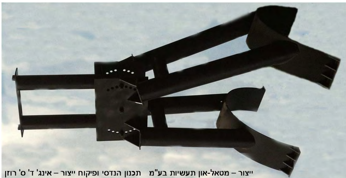
תמונה מס' 1-4 – מבט על המסגרת A שחוברה לכלונס המערבי של הדולפין המערבי באמצעות שתי שלות. רואים רק החצי של החבקים המרותכים למסגרת. בקצה המסגרת חוברו מחברי מד הלחץ, וה-CTD.
