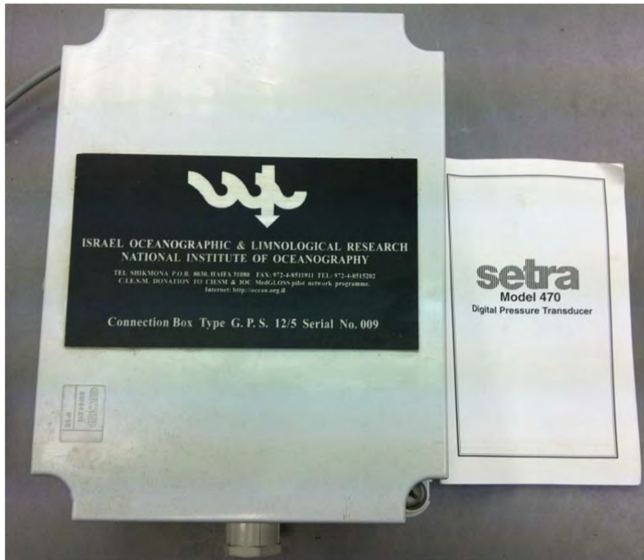
תמונה מס' 1-9 – קופסת המגן של מד הלחץ האטמוספרי SETRA ושל חיישן GPS לתיקוני זמן מדויק
